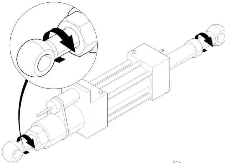
Comprobar la distancia entre centros de los ataques a viga soldados. Si es necesario, ajustar la cota de montaje del conjunto, roscando o desenroscando las varillas.
