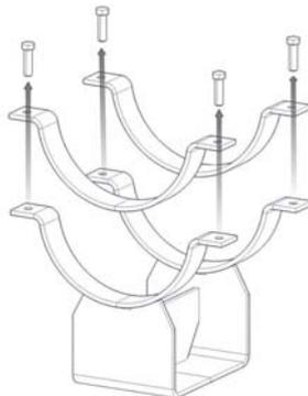
Retirar os parafusos que fixam as duas semiabraçadeiras superiores e soltá-las.
