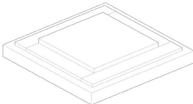
Existem dois tipos de placas de PTFE. Aqui se apresenta a Opção 1. Na Opção 2, a placa base tem orifícios para sua fixação em campo.
