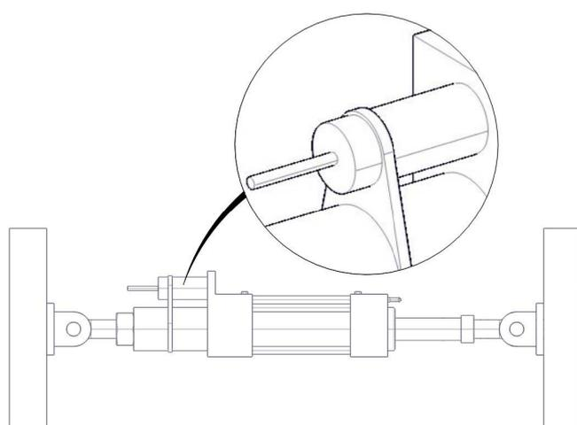
Il est recommandé de situer le réservoir d'huile sur la partie supérieure.
