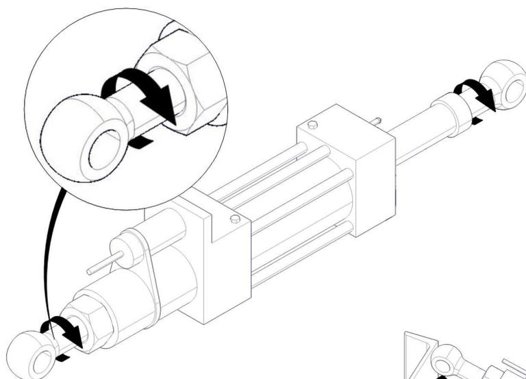
Vérifier la distance entre les centres des raccords à la poutre soudés. Si nécessaire régler la cote de montage de l'ensemble en vissant ou dévissant les tiges.
