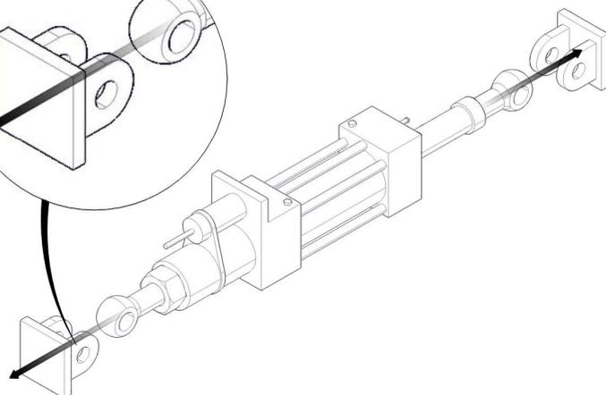
Et retirer les raccords à la poutre des deux côtés.
