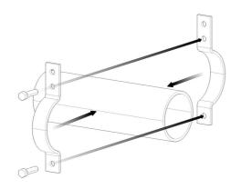
Colocar la abrazadera y los tornillos.
