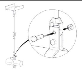
Colocar el tercer tornillo y su tuerca correspondiente en la abrazadera.
