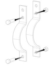
Desmontar los dos tornillos y tuercas que quedan en la abrazadera.
