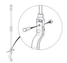
Desatornillar el tornillo y tuerca superiores de la abrazadera de tres tornillos.
