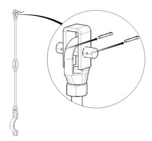
Tal y como se comenta al principio de la guía, existen diferentes configuraciones de colgante, por lo que es posible que la unión superior a viga se realice mediante cáncamo y unión a viga. En todo caso, los pasos a seguir serían los mismos. Sacar los pasadores de aleta del bulón superior.
