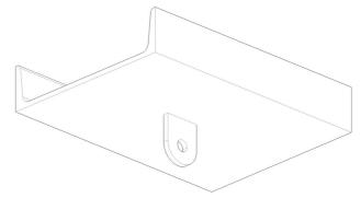
Soldar la orejeta / unión a viga en el lugar correspondiente según planos.
