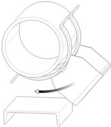
Debe colocarse el conjunto soldado patín-semiabrazaderas soldadas bajo la tubería correspondiente.
