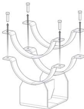
Sacar los tornillos que fijan las dos semiabrazaderas superiores y desensamblarlas.
