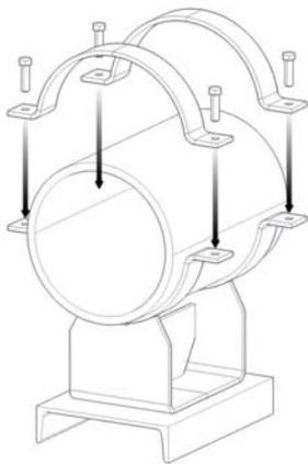
Una vez que el patín está colocado de manera estable, colocar las semiabrazaderas superiores e introducir los tornillos correspondientes.
