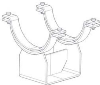
Si el tamaño de tubería no es grande, el patín se enviará premontado y con las abrazaderas superiores hacia abajo.
