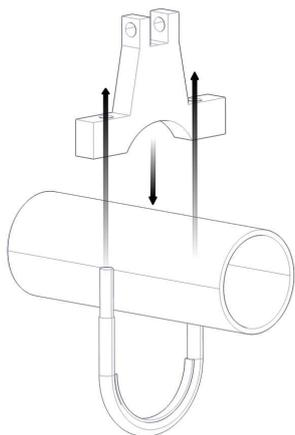
Colocar la abrazadera en la tubería correspondiente de modo que el separador entre en contacto con la tubería de manera estable.
