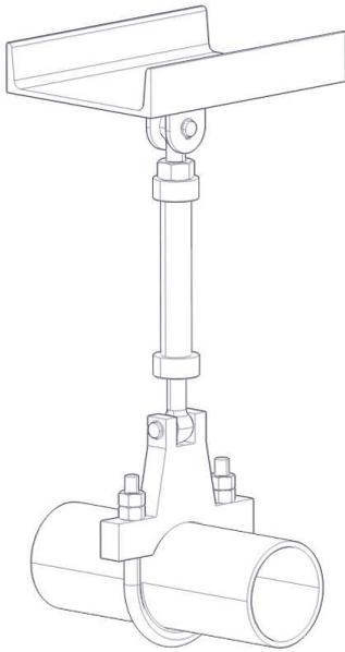
Existen distintos tipos de restricciones mecánicas (opciones 1, 1-A, 2, y 3) que varían según accesorios utilizados. En esta guía se explica el montaje genérico de una restricción mecánica estándar. Si el tamaño de tubería no es grande, la restricción mecánica se enviará premontada.
