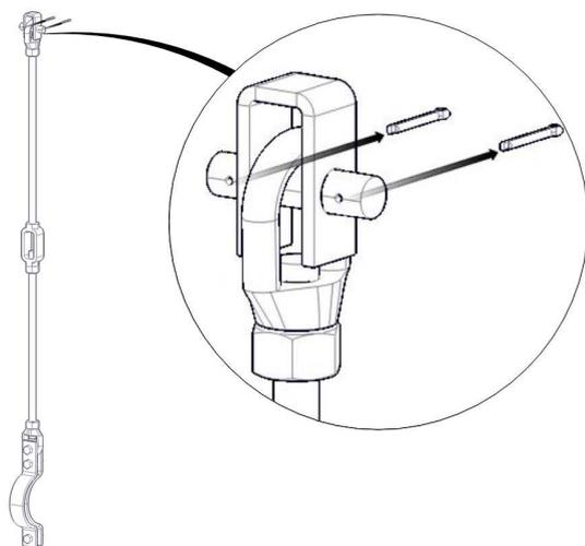
Tal como se comentou no início do guia, existem diferentes configurações de suspensão, portanto é possível realizar a fixação superior à viga por meio de porca olhal e elemento de união à viga. Em qualquer caso, os passos a seguir seriam os mesmos. Retirar os contrapinos da cavilha superior.
