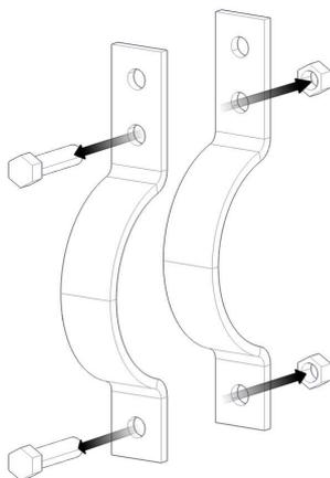
Desmontar os dois parafusos e porcas da abraçadeira.
