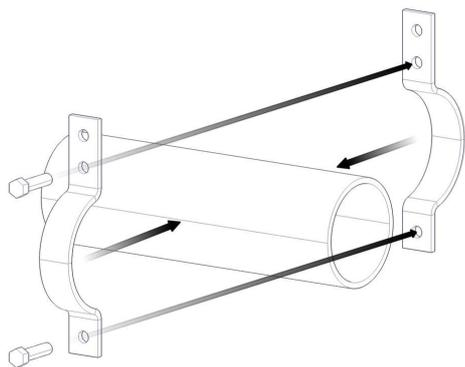
Colocar a abraçadeira e os parafusos.
