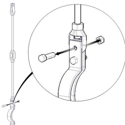
Soltar o parafuso e porca superiores da abraçadeira de três parafusos.
