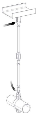
Monter l'ensemble des tiges et régler le vissage des tiges si cela est nécessaire.
