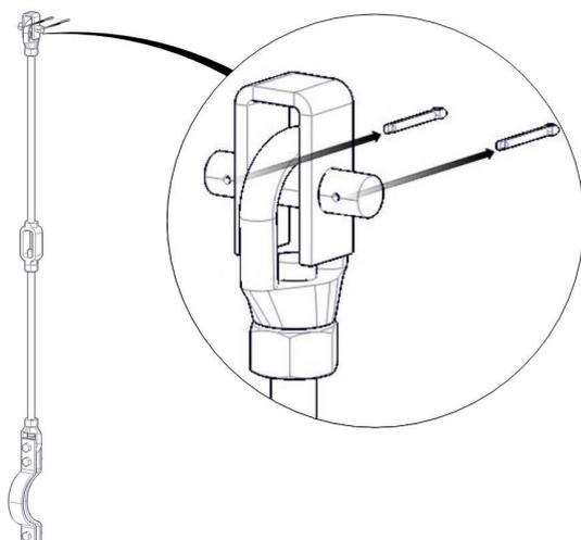
Tel que signalé au début de ce guide il existe différentes configurations de support, ce qui permet que le raccordement supérieur à la structure soit effectué au moyen d'un œillet et d'un raccordement. Les pas à suivre seront en tout cas les mêmes. Retirer les goupilles fendues du boulon supérieur.
