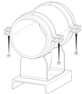
Boulonner et serrer les quatre écrous. D'abord à la main, avec une séquence en forme de croix, et ensuite avec une clé.
