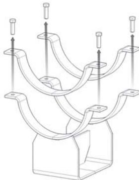
Retirer les boulons fixant les deux demi-colliers supérieurs et désassembler ces derniers.
