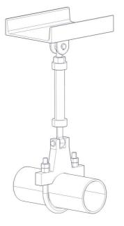
Il existe divers types de contraintes mécaniques (options 1, 1-A, 2, et 3), qui varient en fonction des accessoires utilisés. Dans ce guide le montage générique d'une contrainte mécanique standard est expliqué. Si la tuyauterie n'est pas de grande taille la contrainte mécanique sera livrée prémontée.
